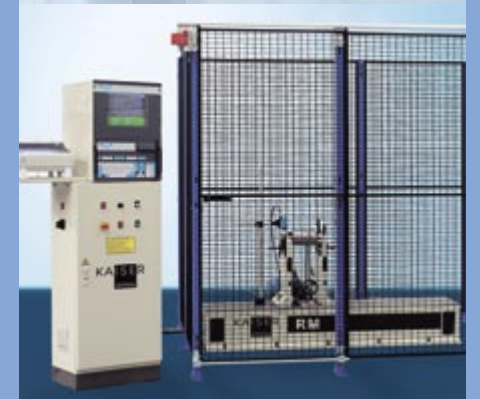
Protección de clase B, (protección contra contacto accidental con rotores).
